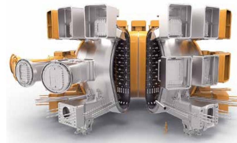
**À L'INTÉRIEUR, UN COMPLEXE SYSTÈME DE PLAQUES ET CANAUX AVEC LE DOUBLE OBJECTIF DE REFROIDIR LE COMPOSANT ET BLINDER LA RADIATION NEUTRONIQUE PRODUITE PAR LA RÉACTION DE FUSION.**
