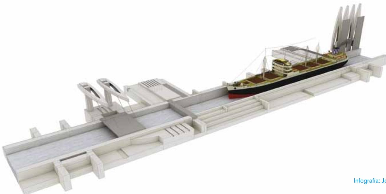
1. La nueva infraestructura tiene una longitud total de 434 metros y 35 metros de manga útil que posibilita la entrada de barcos de hasta 292 metros de eslora.
