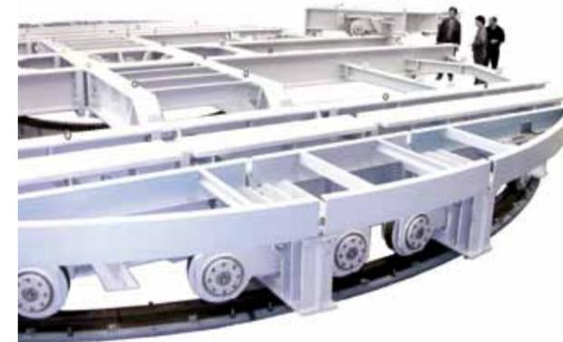
**01 / Una estructura apoyada sobre bogies con un mecanismo rotatorio, cuya finalidad es girar 180 grados a la locomotora que tracciona a los buques, cuando se llega al final del trayecto**
