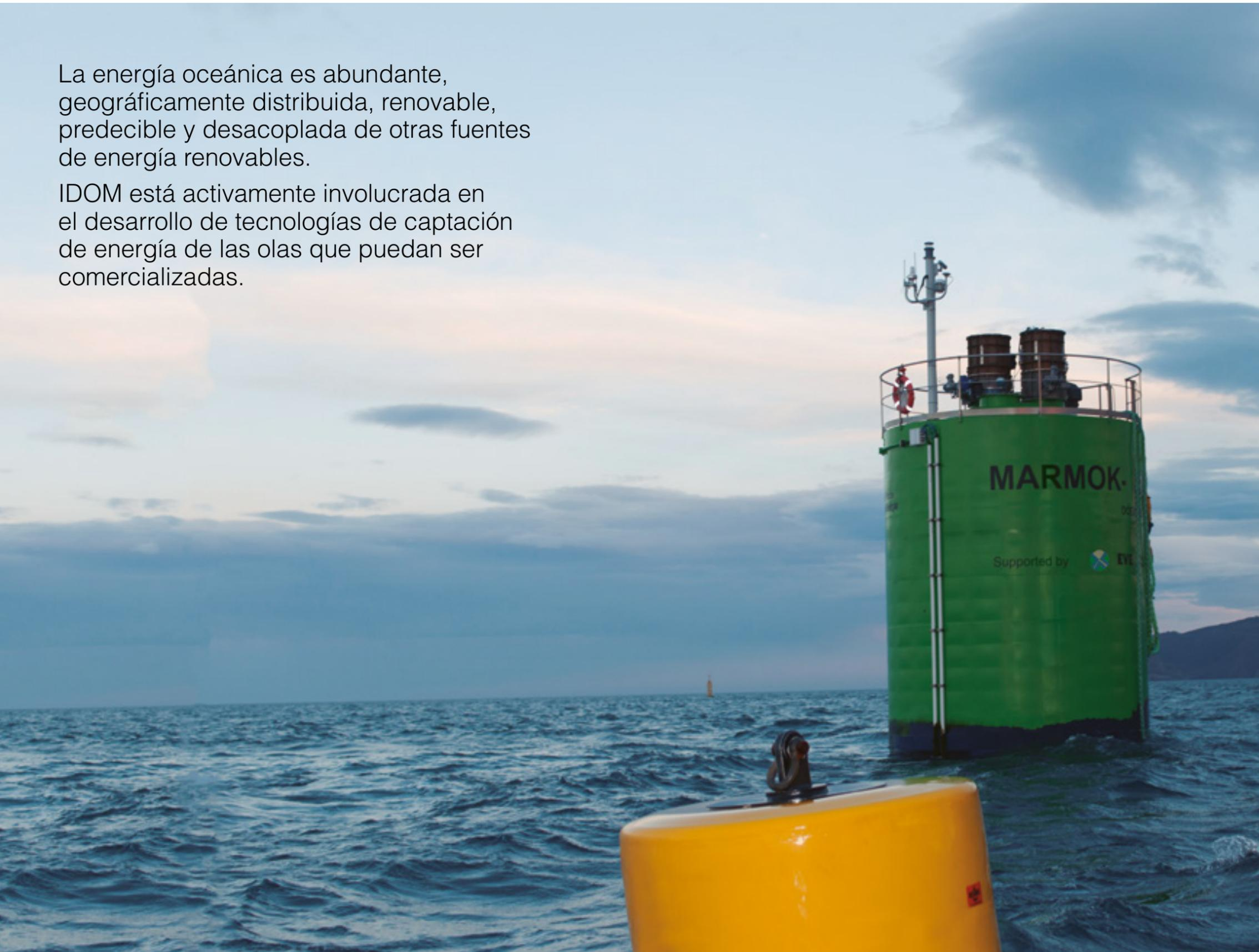
**MARMOK-A-5 Captador de energía de las olas (WEC). Un dispositivo flotante, basado en la tecnología de columna de agua oscilante**
